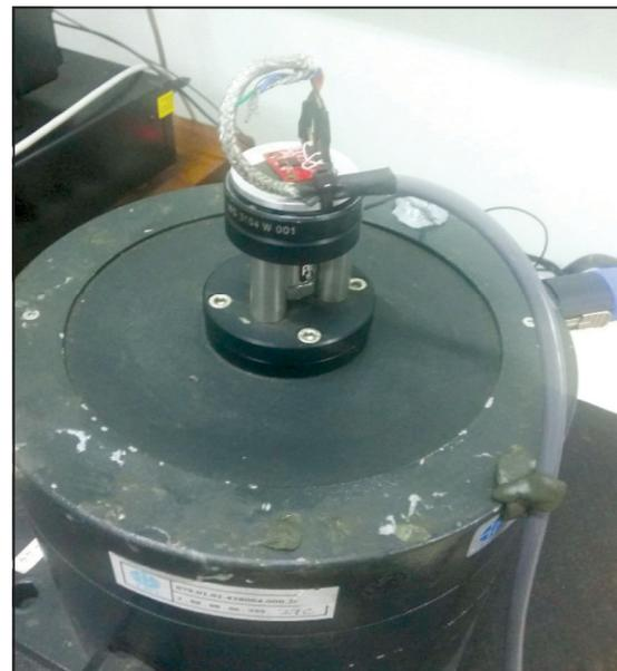
**Gambar 12.** Pemasangan Sensor ADXL345 dalam Proses Kalibrasi Bersama Sensor Standar
